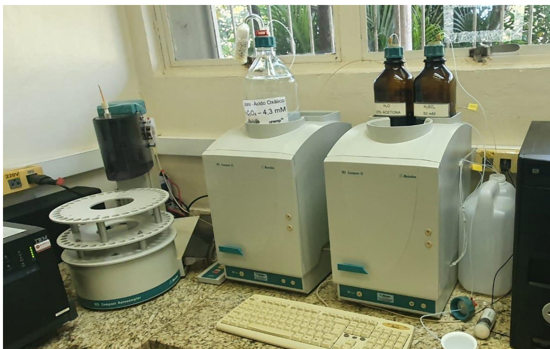
Figura 10. Cromatógrafo de íons (IC), marca Metrohm, modelo 761 Compact.
