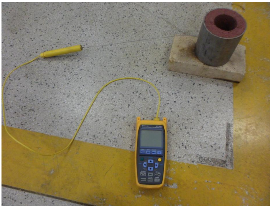
Figura 16: Montagem para a leitura da curva de resfriamento.
