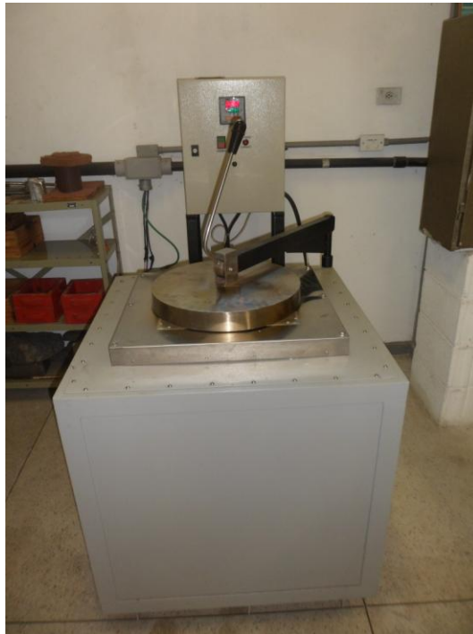
Figura 7: Forno utilizado para a fundição da liga de alumínio AA356 (UNESP/FEG).
