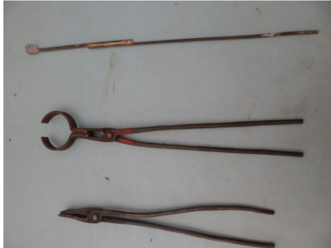
Figura 9: pinças e bastão para a remoção da escória.
