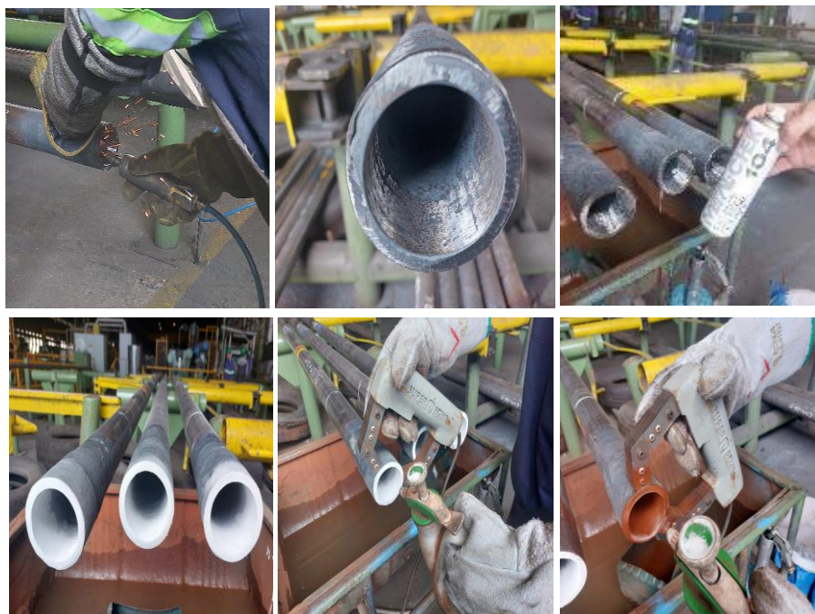
Figura 13 - Realização do ensaio de partículas magnéticas
