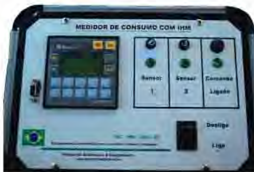
Figura 4. Controlador lógico programável, utilizado para coleta e armazenamento de dados.
