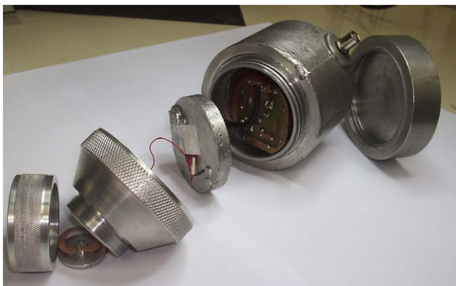
Figura 3.8 - Câmara Piroelétrica blindada com alloy , vista interna.
