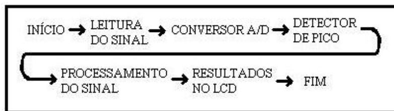
Figura 3.10 - Seqüência lógica das operações realizadas pelo microcontrolador.
