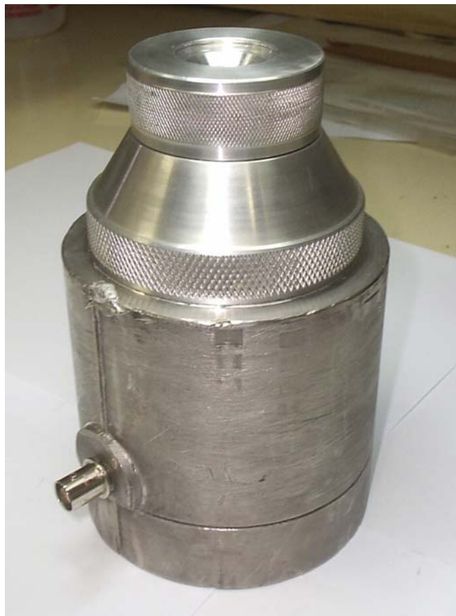
Figura 3.7 - Câmara piroelétrica blindada com alloy , vista externa.
