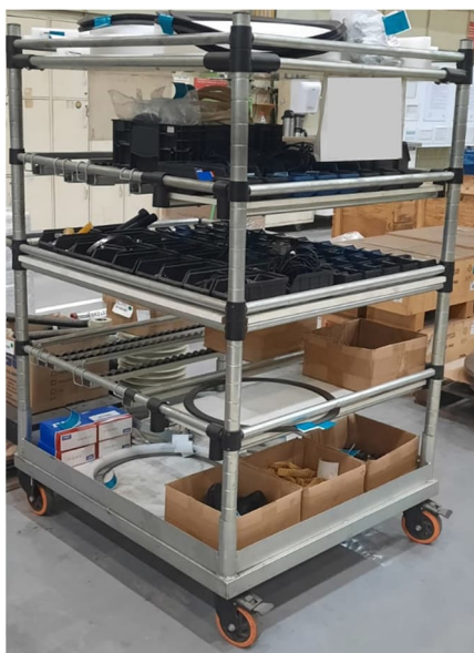
Figura 20 – Rack metálico utilizado para entrega de peças
