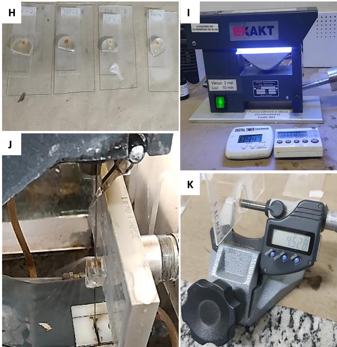
Figura 7 – H: Lâminas montadas para corte na região central do defeito utilizando a serra do Exakt. I: Prensa adesiva à vácuo (sanduicheira) em funcionamento para preparação da lâmina de estudo. J: Serra do sistema Exakt em funcionamento. K: Checagem da espessura das amostras após desgaste e polimento no sistema Exakt.
