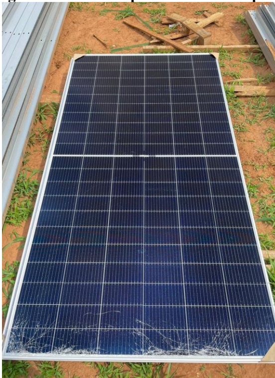
Figura 30: Módulo quebrado no transporte
