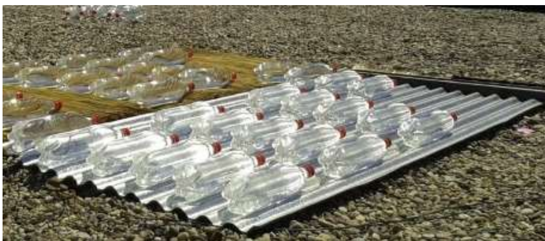
Figura 6 – SODIS com telhas de aço galvanizado e garrafas PET
