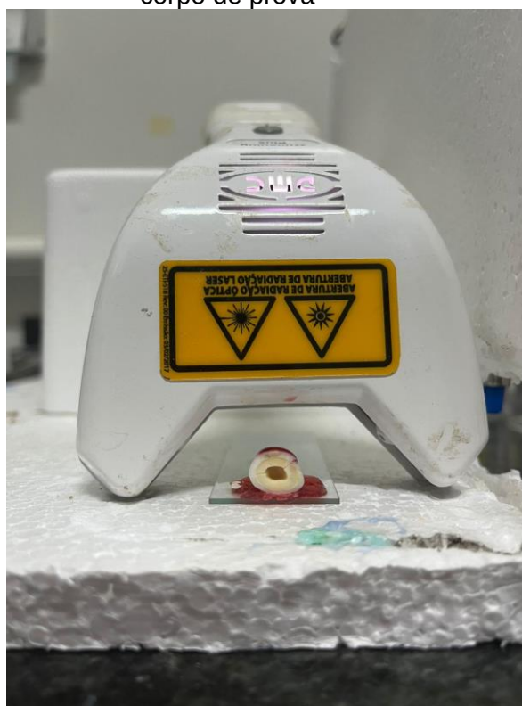
Figura 3 - Disposição do equipamento de clareamento fotoativado em relação ao corpo de prova
