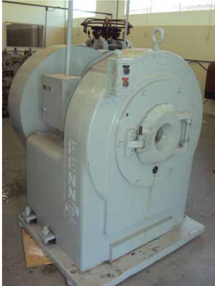
Figura 13 – Prensa rotativa empregada para obtenção das barras
