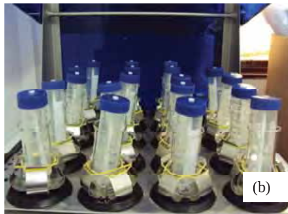
Figura 17 – Imersão em SBF: (a) Representação esquemática da amostra no tubo Falcon; (b) Montagem dos tubos em uma mesa agitadora.
