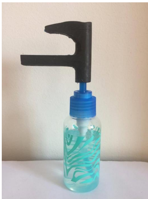
Figura 14 – Impressão 3D do dispositivo acoplado ao acionado da válvula Pump .
