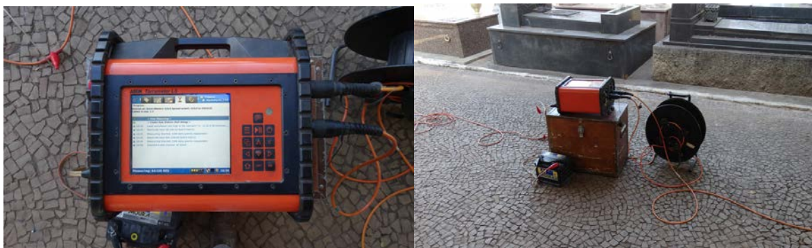
Figura 13: À esquerda, Resistivímetro utilizado para levantamentos geofísicos. Fonte: Acervo pessoal.
