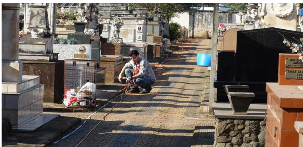
Figura 15: Inserção dos eletrodos metálicos no solo. Fonte: Acervo pessoal.
