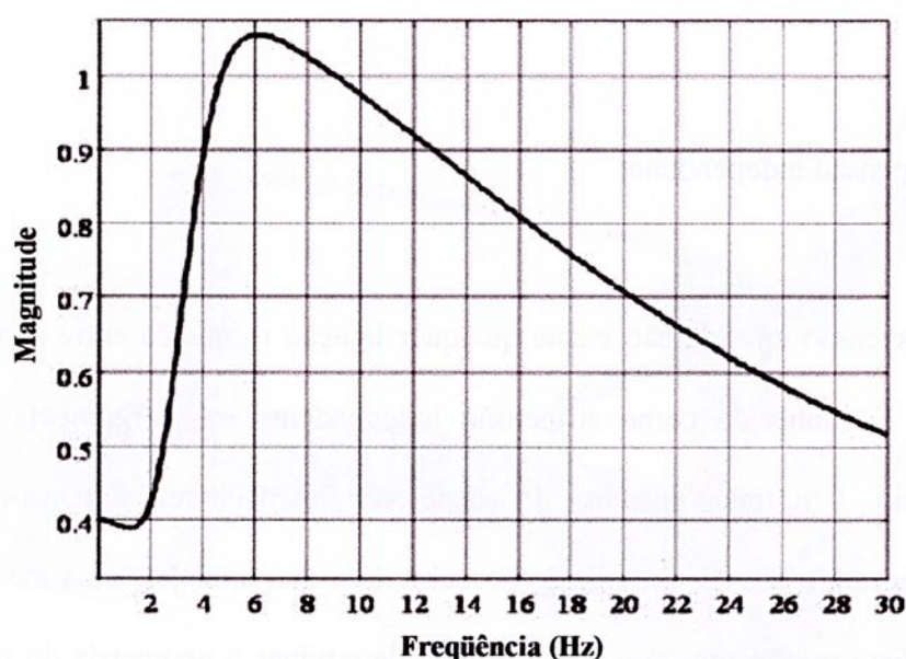
Figura 2.1 - Magnitude de vibração num corpo humano em função da frequência, levando-se em consideração o efeito da vibração vertical
