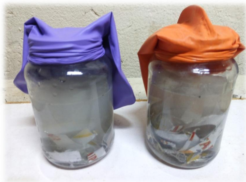
Figura 12 - Início da reação: em solução alcalina fechada por balão de ensaio de H_2 .
