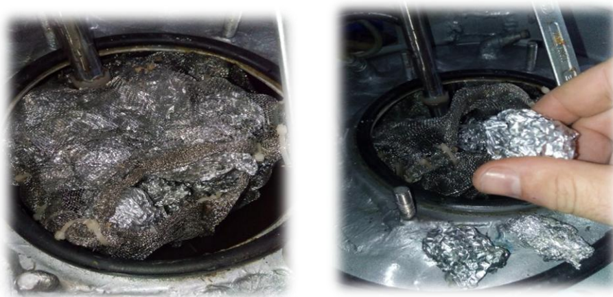
Figura 47 - Apresenta a inserção de folhas de alumínio em cesto móvel.
