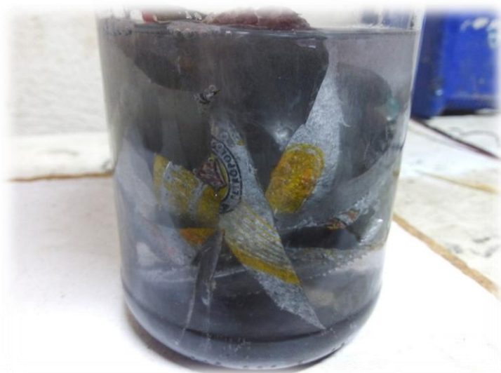
Figura 14 - Avanço da reação formação de bolhas e aparecimento de alumina e H_2 .
