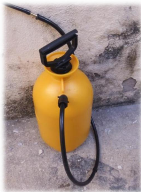
Figura 24 - Aspecto do vaso de pressão de reação utilizado.
