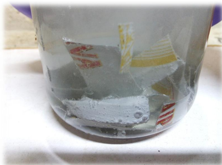
Figura 13 - Reação em solução alcalina formação de bolhas de H_2 .
