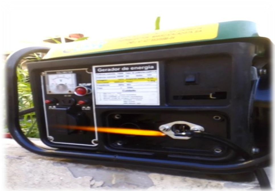
Figura 25 - Motogerador de energia e agulha para injeção do combustível no carburador
