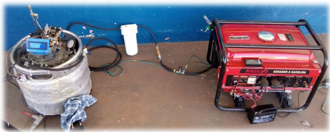
Figura 46 - Sistema de imersão alimentando motogerador de 3KW
