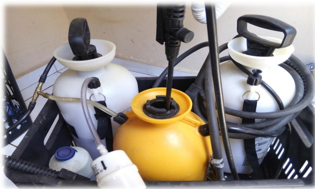
Figura 32 - Sistema de controle mecânico manual para controle da reação H_2 com 3 vasos de pressão
