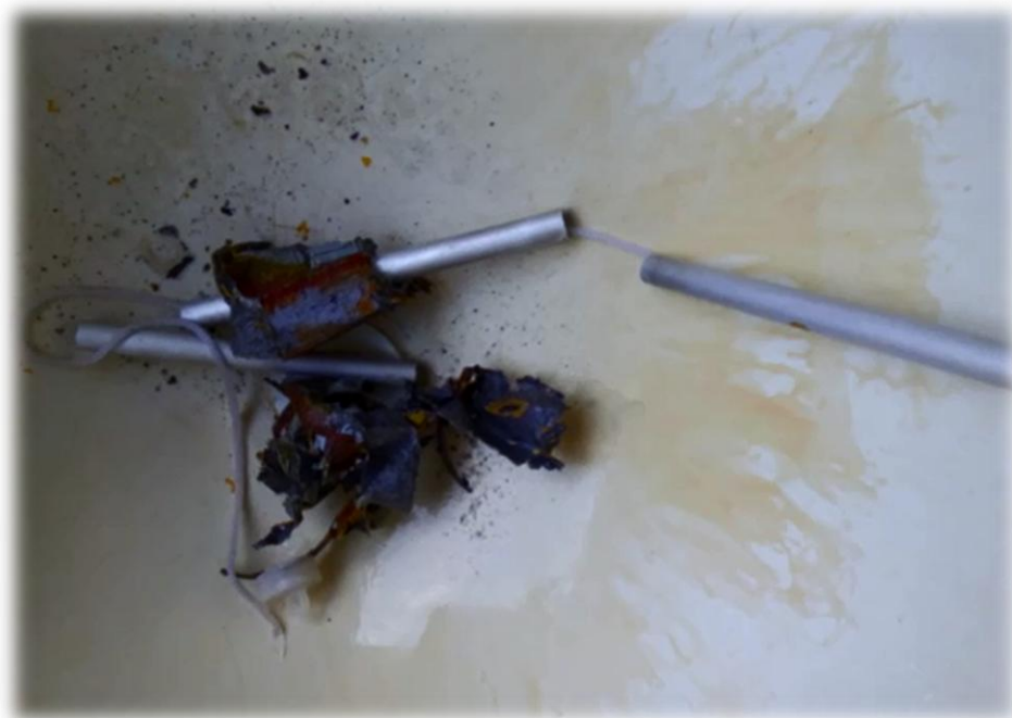
Figura 29 - Óxido de alumínio – alumina e restos de alumínio não consumido.
