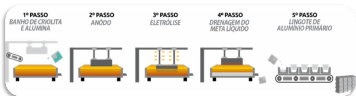
Figura 2 - Processo de produção do alumínio a partir da alumina.
