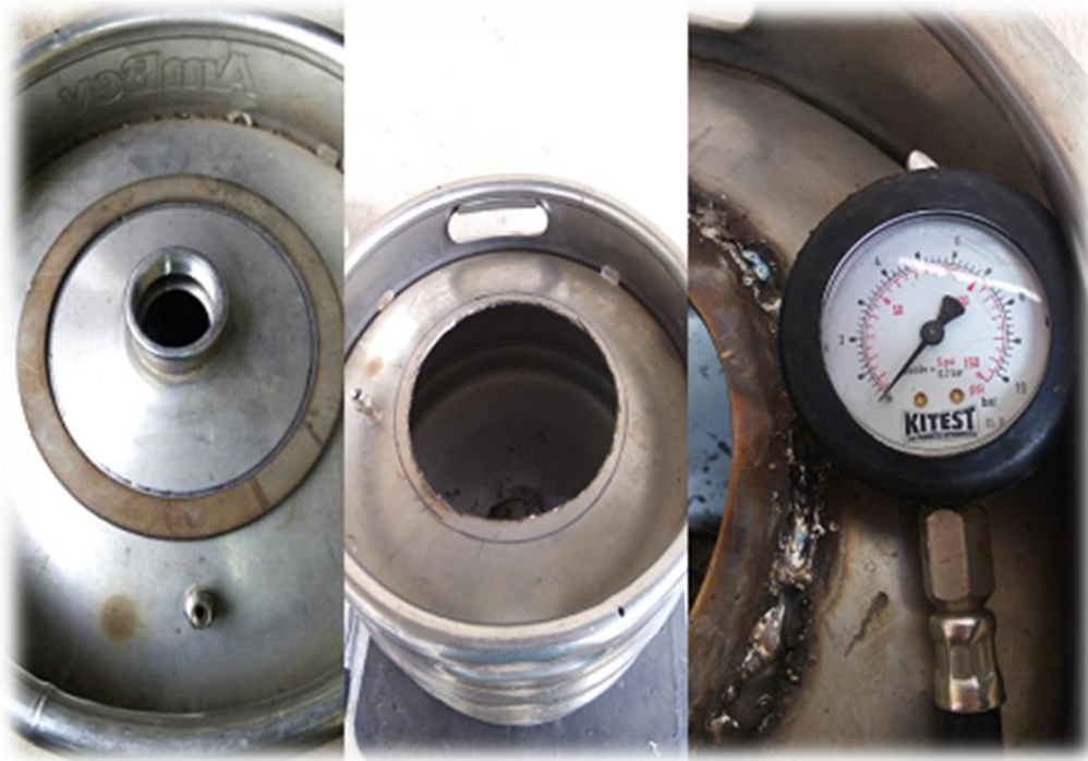
Figura 35 - Vasilhame de aço inox-316L de 30l em processo de fabricação.
