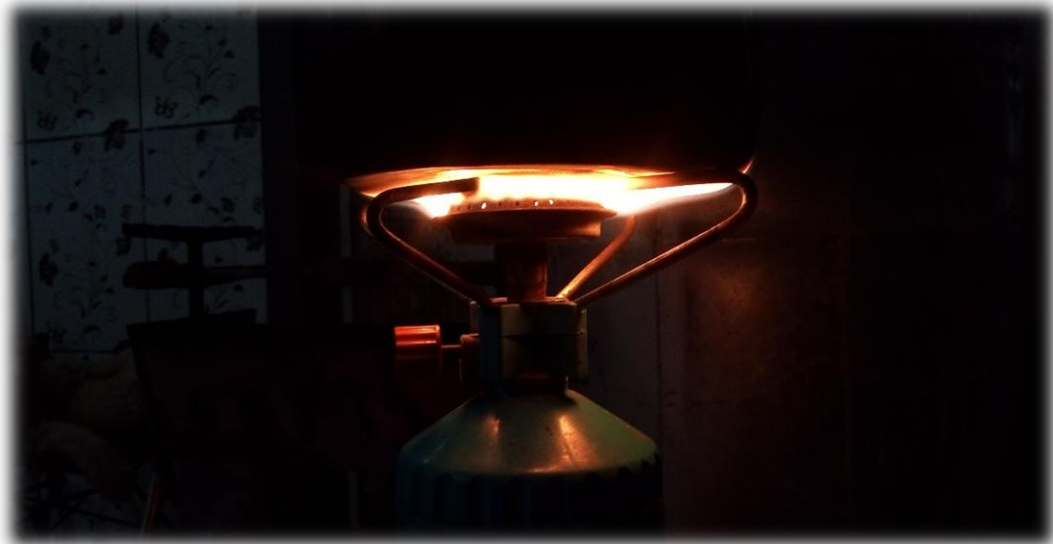
Figura 44 - Fogareiro a 100% hidrogênio aquecendo a massa de 1kg de água 8 lpm H_2
