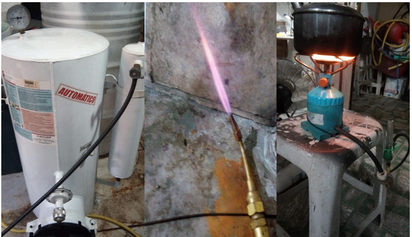
Figura 53 - Reator de hidrogenio 80 litros e chamas de teste
