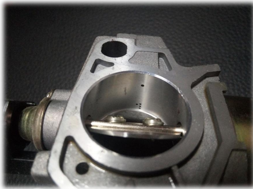
Figura 59 - Carburador e orifícios de saída do hidrogênio
