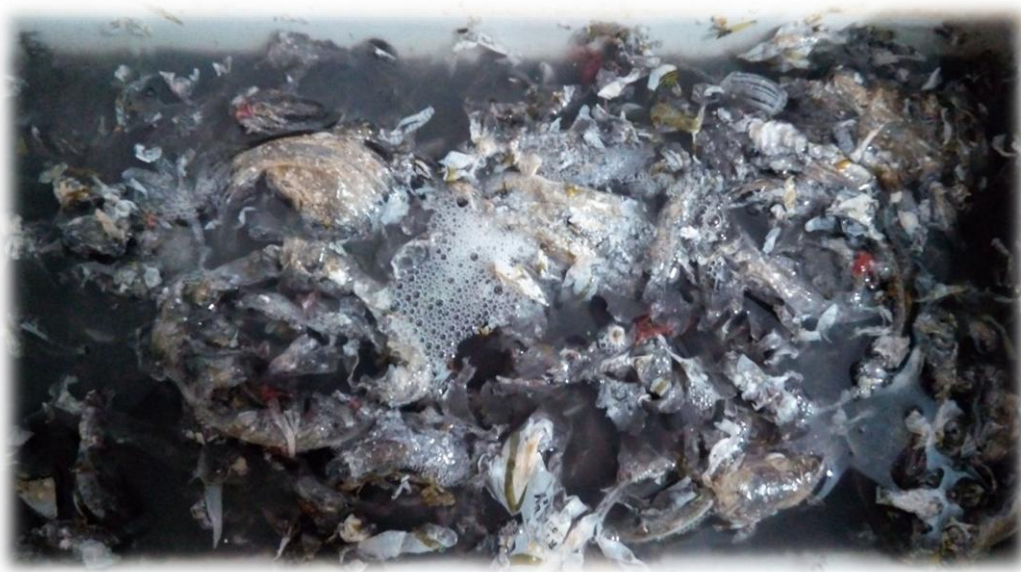
Figura 51 - Bandeja de reação do reator de 80 litros em estado final com todo o material consumido pela reação
