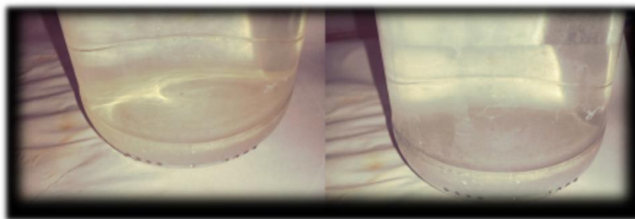
Figura 16 - Aspecto final da reação completa com alumina ao fundo.
