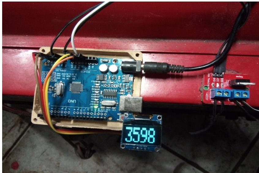
Figura 60 - Circuito de controle do injetor de hidrogênio
