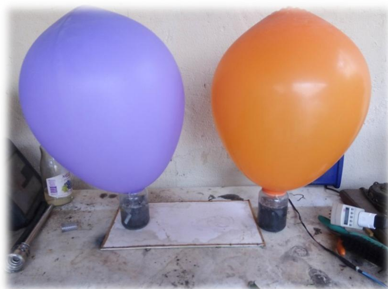
Figura 15 - Volume máximo alcançado com o total de H_2 produzido.
