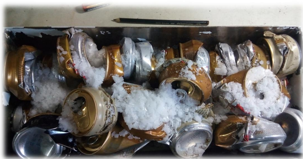
Figura 50 - Bandeja de reação do reator de 80litros em estado inicial
