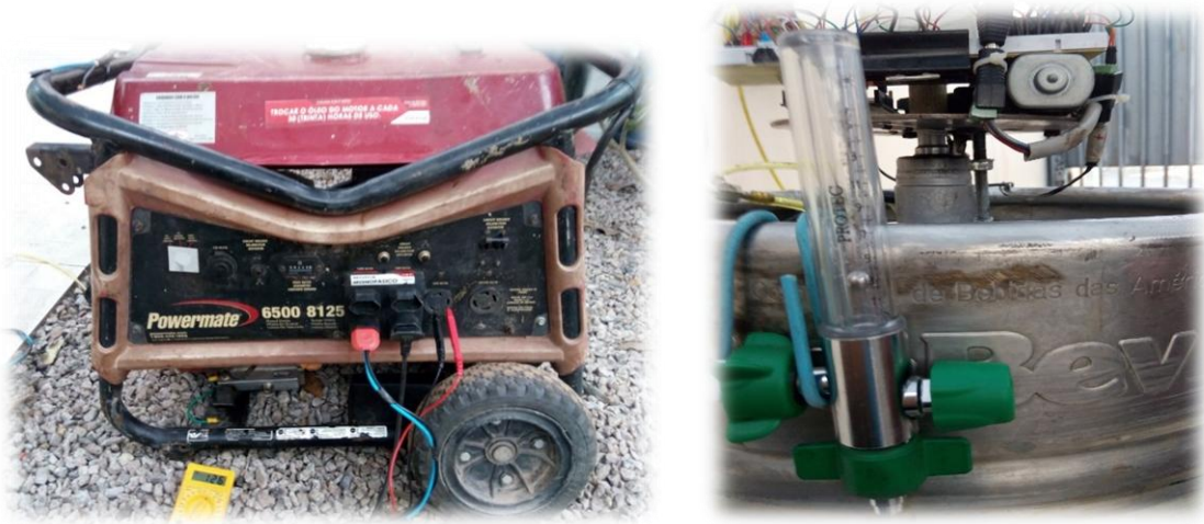
Figura 45 - Aspecto do motogerador utilizado de 6,5 kW
