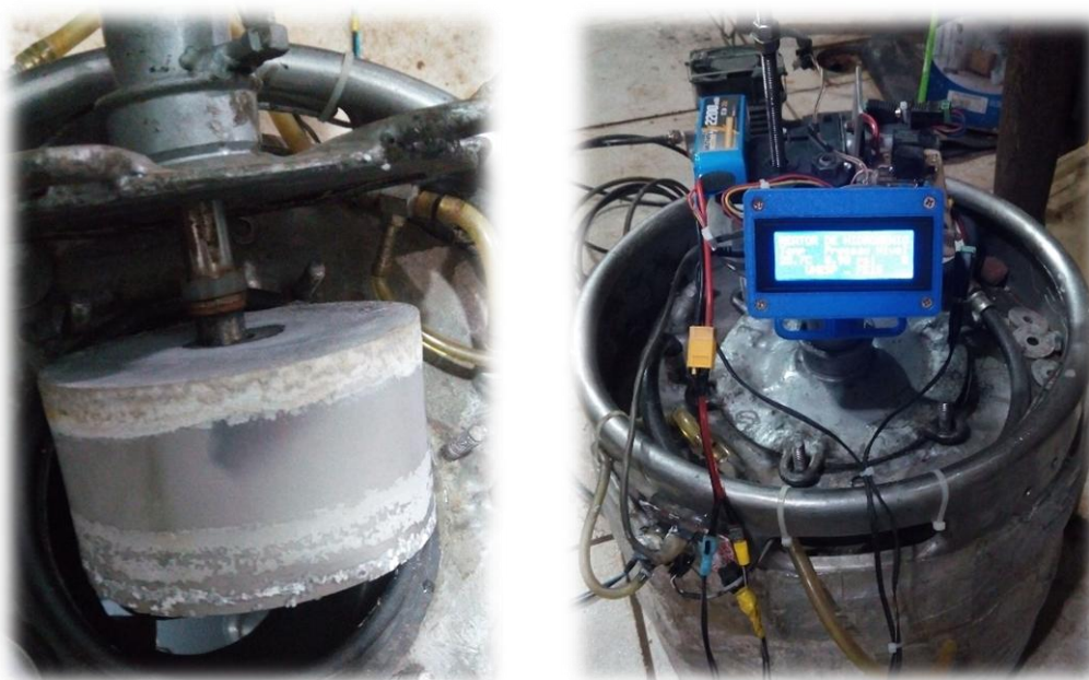
Figura 48 - Bloco de alumínio e o sistema fechado em produção de Hidrogênio.
