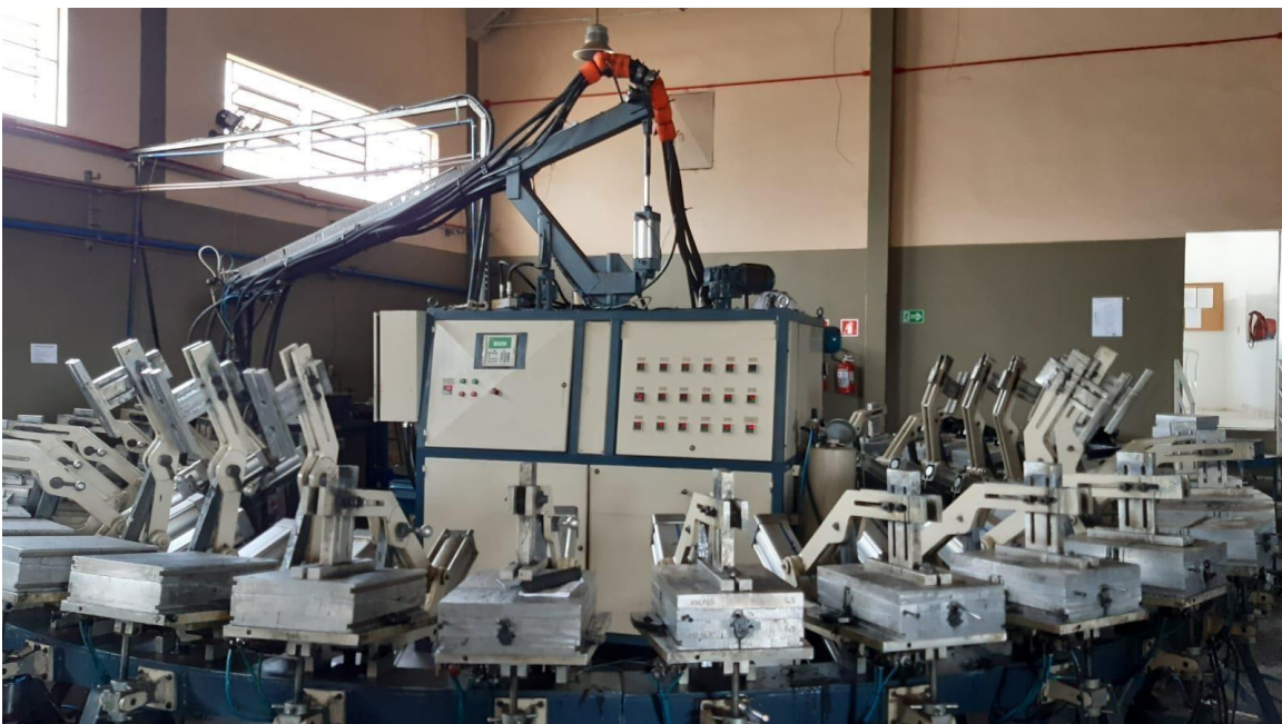
Fotografia 6: Maquinário de produção de solados da Sola Nova Industrial Ltda. que comporta diversos trabalhadores simultaneamente.
