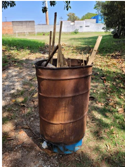
Figura 6 – Tambor contendo o reator e a biomassa utilizada como combustível
