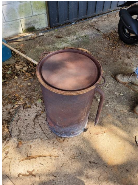
Figura 4 - Reator fechado pronto para iniciar o processo de pirólise
