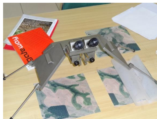
Foto 18. Processo de retirada das feições morfológicas das fotografias aéreas através da estereoscopia. Foto do autor.
