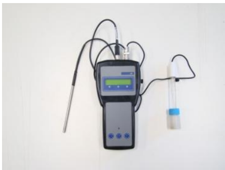
Foto 1. Medidor de pH digital portátil, Tecnozon, modelo mPA 210 PA. Foto do autor.
