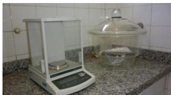
Foto 11. Balança analítica Shimadzu modelo AW220
