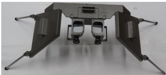
Foto 17. Estereoscópio modelo Topcon Model 3 Mirror Stereoscope. Foto do autor.
