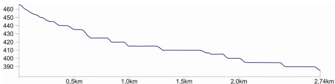
Figura 27. Perfil longitudinal do afluente do córrego do Lajeado. Fonte: modelagem a partir da carta topográfica com equidistância das curvas de 5 metros (elaborado pelo autor).
