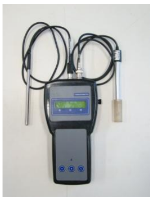
Foto 3. Medidor de condutividade portátil, Tecnozon, modelo mCA 150P, Foto do autor.
