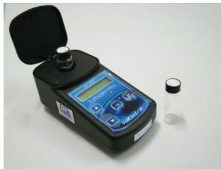
Foto 2. Medidor de turbidez portátil, modelo AP-2000. Foto do autor.
