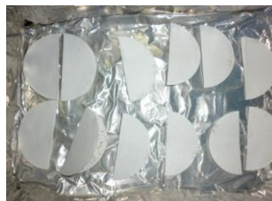
Foto 13. Filtros de membrana de fibra de vidro
