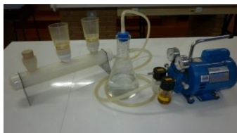
Foto 12. Bomba à vácuo Prismatec modelo 131
