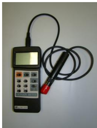
Foto 4. Medidor de oxigênio do ar / dissolvido/ temperatura digital portátil modelo DO-5510. Foto do autor.
