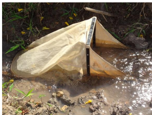
Foto 6. Coletor Surber sendo utilizado no campo. Foto do autor
