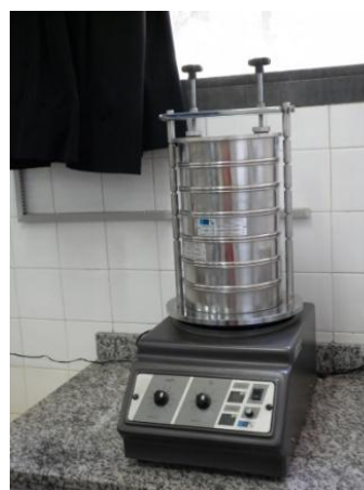
Foto 16. Agitador RODAP com peneiras para fracionamento de sedimentos. Foto do autor
