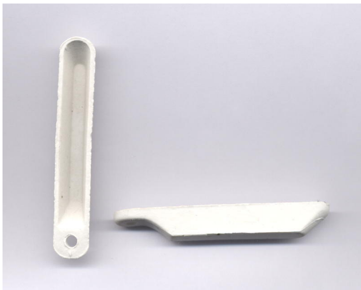
Figura 9 – “Barquinhas” de alumina utilizadas como suporte das amostras no tratamento térmico.
