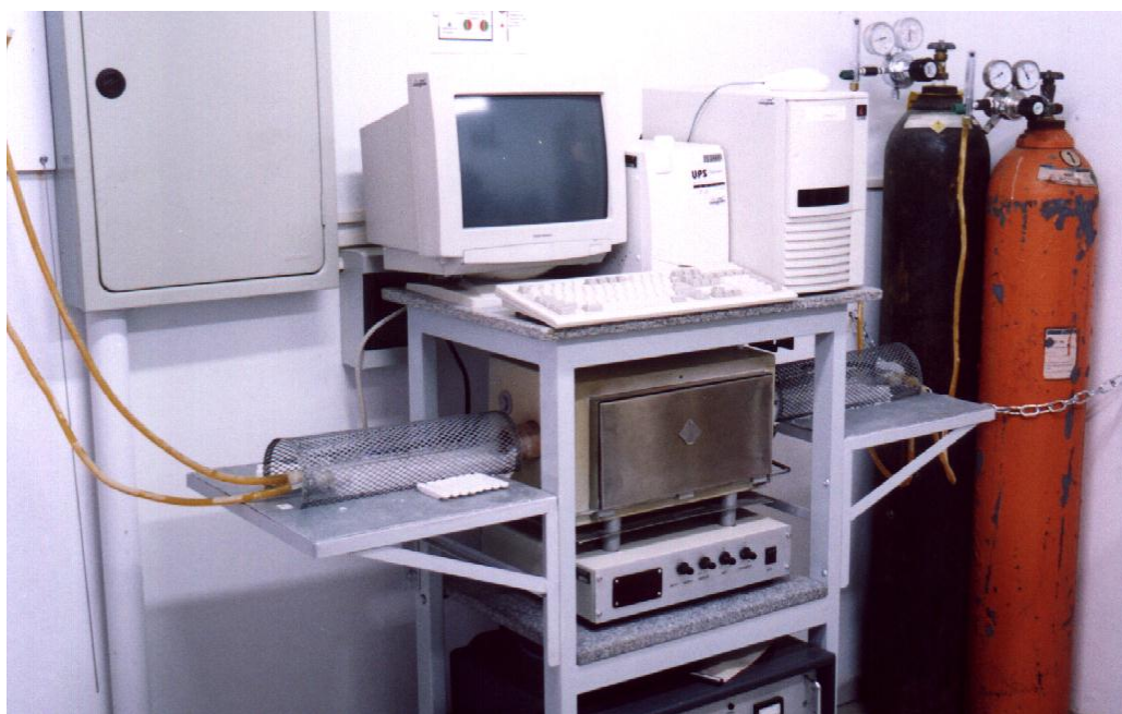
Figura 10 – Arranjo Experimental do forno com o acoplamento dos tubos de quartzo.
