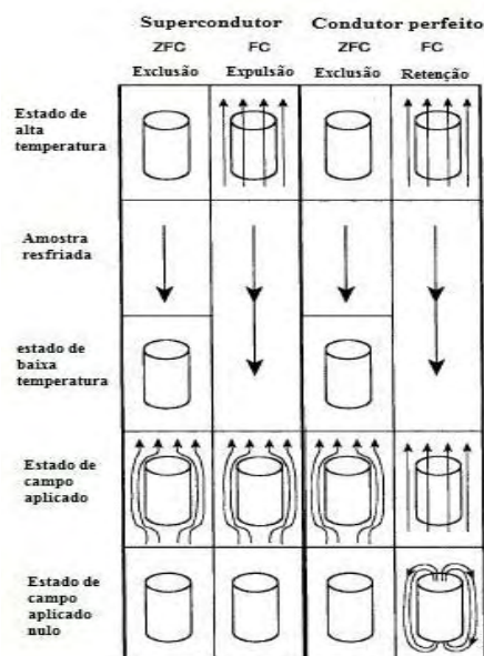
Figura 4- Efeito Meissner-Ochsenfeld com o material resfriado sem a presença de campo (ZFC) e material resfriado após o campo magnético ser aplicado (FC) de um cilindro sólido supercondutor (esquerda) e um condutor perfeito (direita) 16 .
