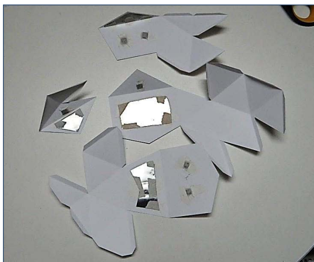
Figura 103 – Fotografia mostrando a colagem das chapas de aço e ímãs de neodímio nas peças seccionadas do icosaedro regular.
