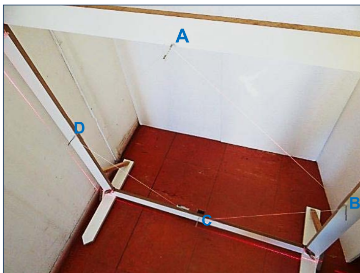
Figura 125 – Esquema de como ajustar os planos de luz.
