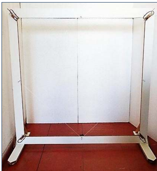
Figura 123 – Nossa máquina para visualização de seções em sólidos geométricos.
