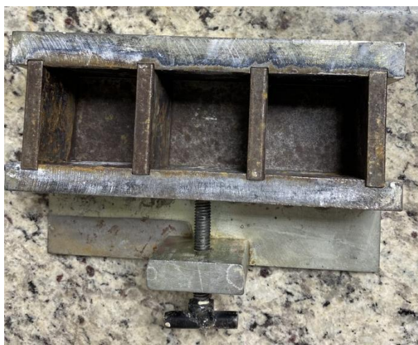
Figura 7. Forma cúbica tripla de 50X 50 X50 mm 3 para a obtenção dos corpos de prova.
