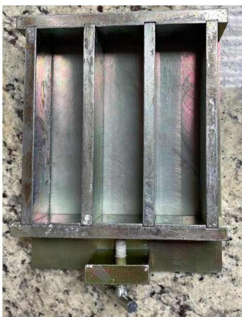
Figura 8. Forma prismática tripla de 40x40x160 mm 3 para a obtenção dos corpos de prova.
