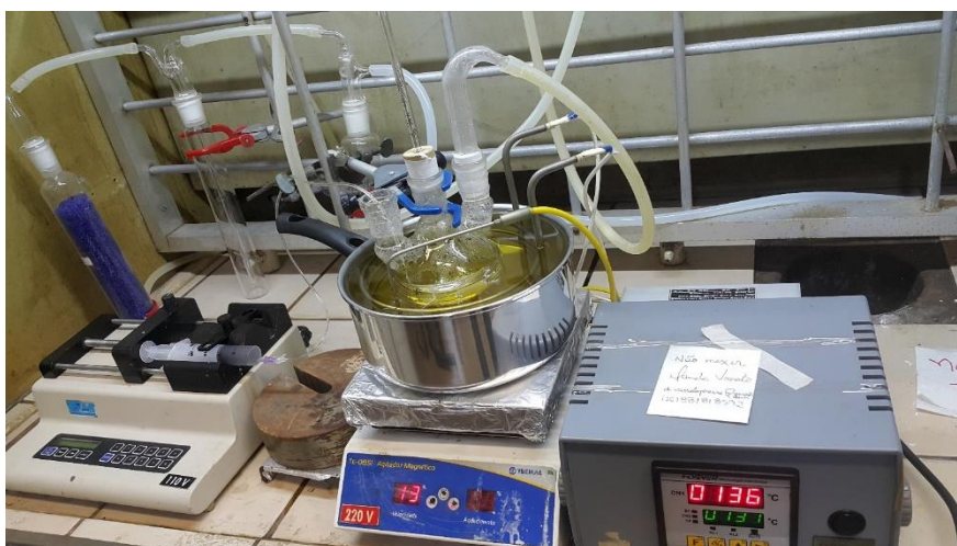
Figura 8 – Sistema de síntese dos nanofios de prata.
