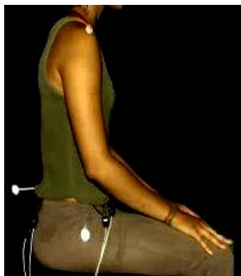
Figura 2. Posição sentada neutra e marcadores fotoreflexivos durante os testes.
