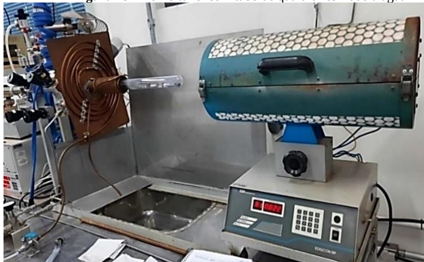
Figura 19 – Forno túnel com tubo de quartzo resfriado à água
