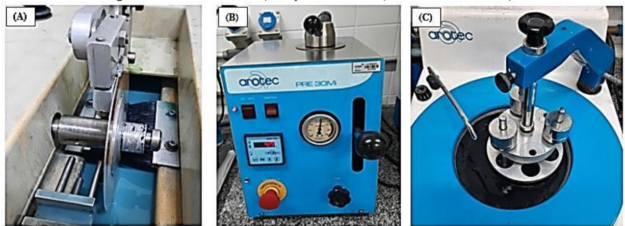
Figura 21 – Embutimento. A) Máquina de corte. B) Prensa embutidora. C) Politriz.
