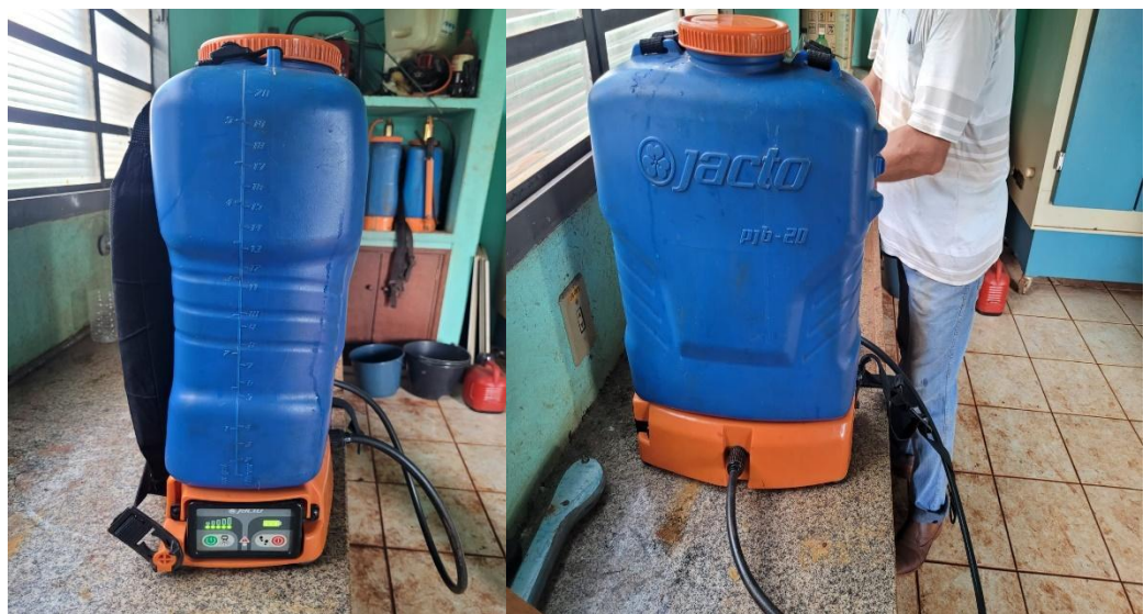
Figura 7 - Pulverizador elétrico de pressão constante, Selvíria – MS, 12/01/2023.
