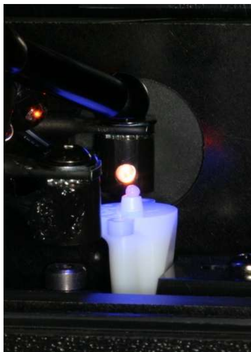
Figura 2- Fotoativação do corpo-de-prova
