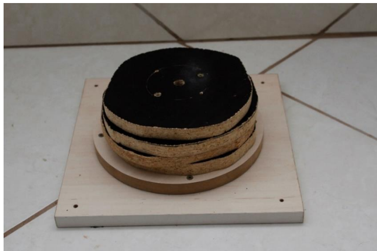
Figura 25: Placas espaçadoras sendo fixadas.
