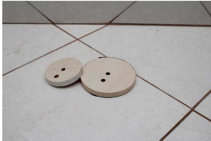
Figura 30: Discos de MDF para a base de fixação do globo terrestre.
