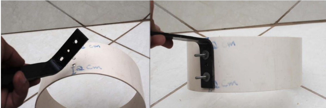
Figura 26: Barra sendo parafusada na lateral do cano PVC.
