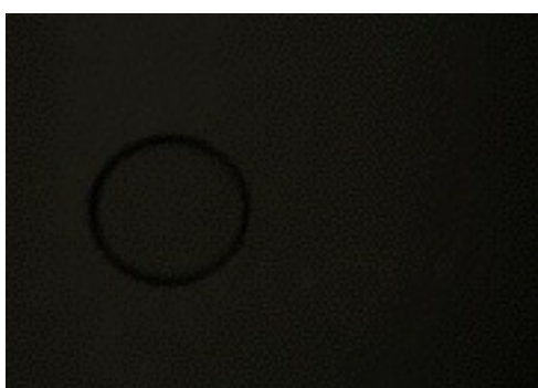
Figura 11. Fotomicrografia correspondente a MLP de CLs liotrópicos anisotrópicos de mesofase cúbica que é caracterizada pela presença de campo escuro. Aumento focal: 40x.
