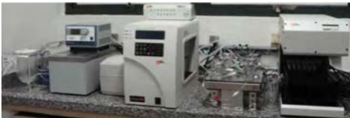
Figura 4. Sistema automático com célula de difusão vertical de Franz – Microette Plus.
