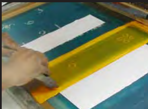
4. Impressão com a tinta epóxi amarela, sendo aplicada com o esfregador de borracha.
