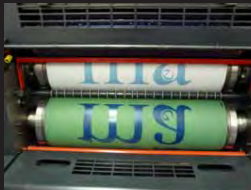
2. Cilindro da chapa onde está a matriz da imagem e o de borracha (cauchu) ainda sem a transferência da imagem.
