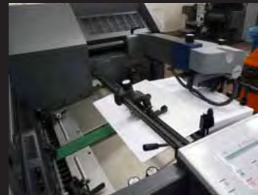
3. Entrada da máquina Offset, onde acontece a alimentação das folhas.
