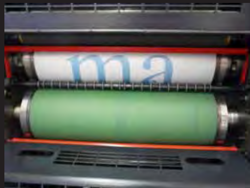
2. Cilindro da chapa onde está a matriz da imagem e o de borracha (cauchu) ainda sem a transferência da imagem.
