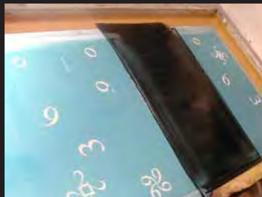
2. Matriz com o papel ao fundo com a tinta epóxi preta já aplicada.
