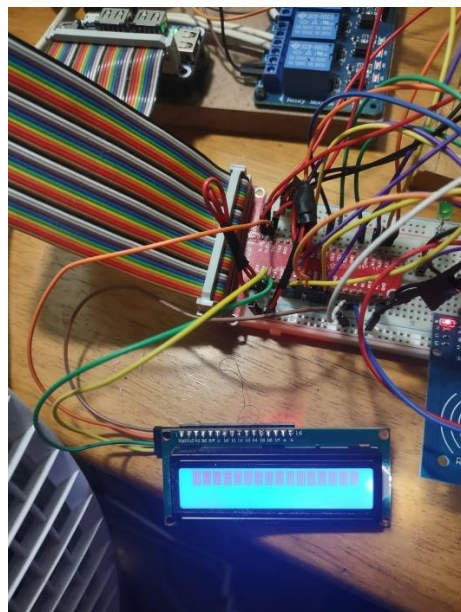
Figura 52: Circuito implementado na protoboard para display LCD 16x2 I2C
