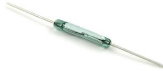
Figura 11: Fotografia do sensor Reed Switch
