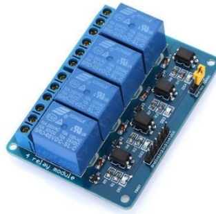
Figura 9: Módulo de relés
