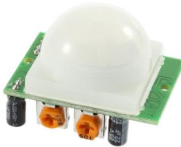
Figura 6: Fotografia do sensor PIR DYP_ME003
