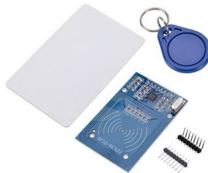
Figura 8: Fotografia do módulo RFID
