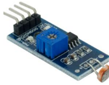
Figura 5: Fotografia de um sensor LDR
