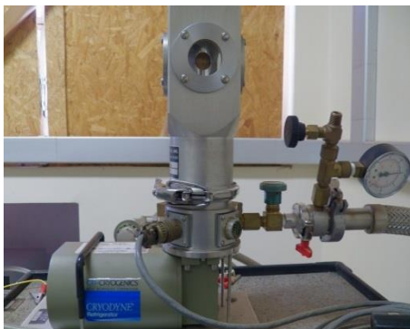
Figura 26: Fotografia do criostato utilizado durante os experimentos.
