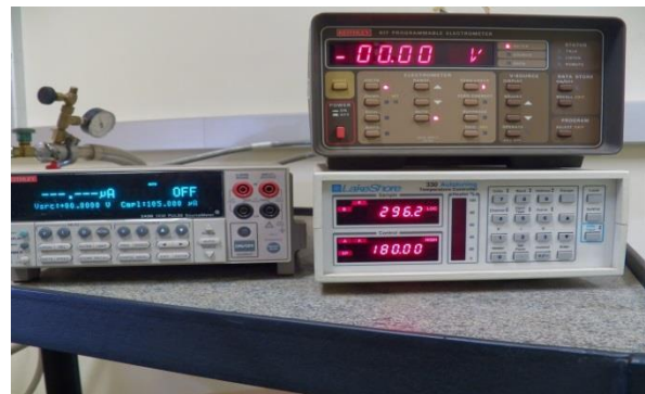
Figura 27: Esquerda: Keithley 2430. Direita: Keithley 617 (em cima) e Controlador de Temperatura (em baixo).
