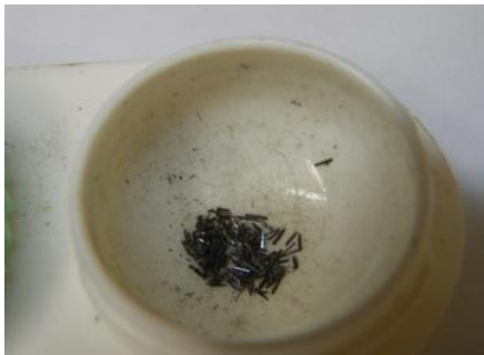
Figura 16: Monocristais de ludwigita homometálica de ferro no interior de um recipiente plástico.
