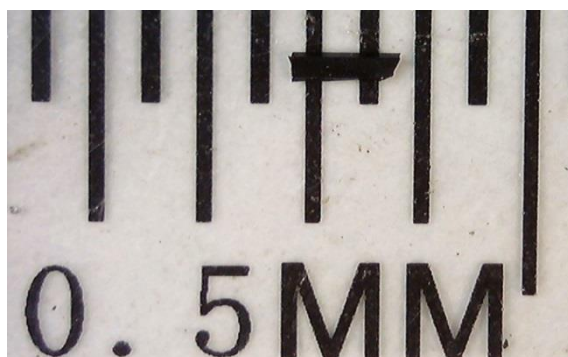
Figura 25: Fotografia em zoom da amostra sobre uma escala com resolução de 0,5mm.
