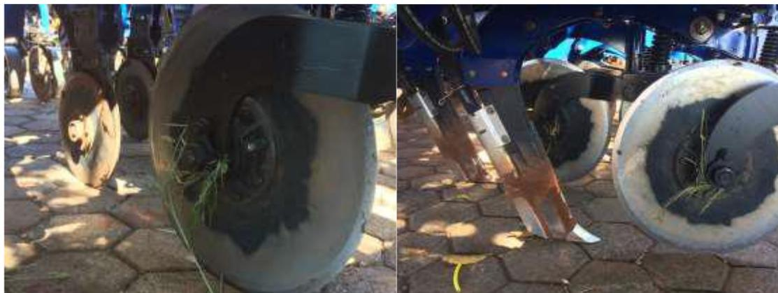
**Figura 2.** Modificação realizada no conjunto semeadora-adubadora, sendo a esquerda disco duplo desencontrado e a esquerda haste sulcadora, ambos na sequência do disco corta palha.
