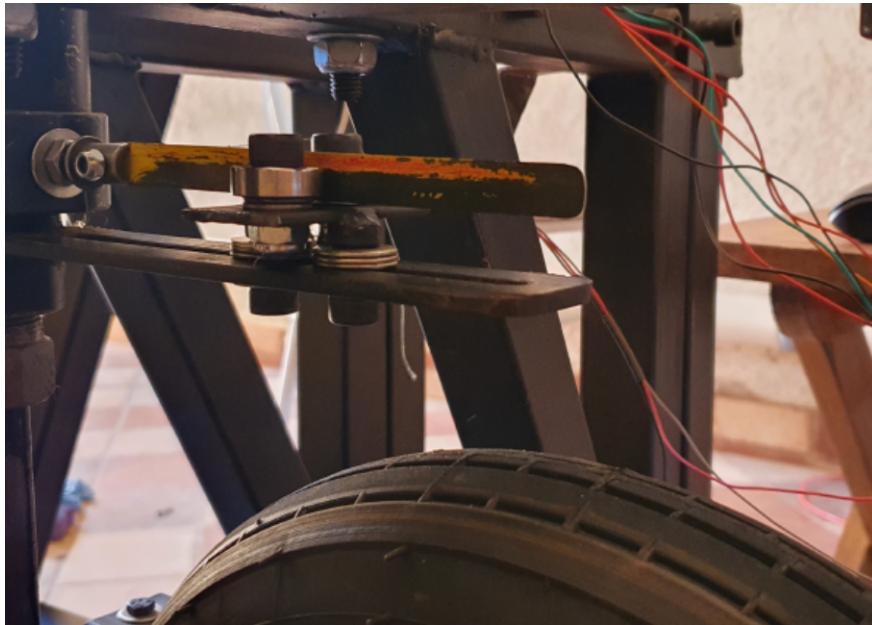
Figura 49 – Fotografia do aparato experimental em detalhe da alteração da barra de flexão para exibir shimmy.
