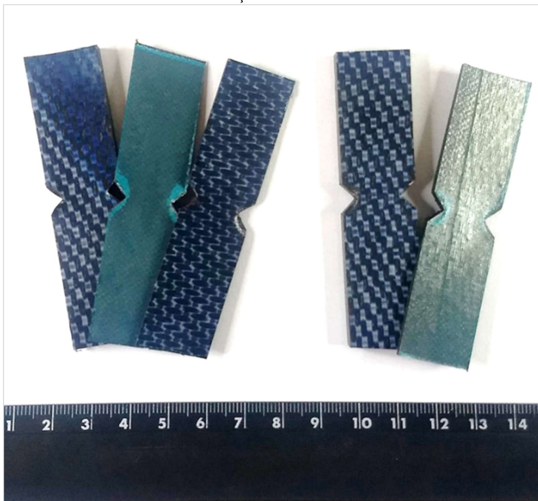
Figura 45: Corpos de prova de Iosipescu do HTCL com adesivo delaminados durante a confecção dos entalhes
