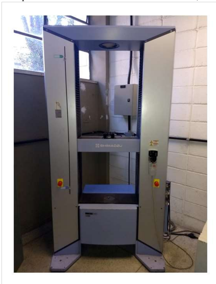
Figura 25: Máquina universal de ensaios mecânicos Shimadzu, modelo AG-X
