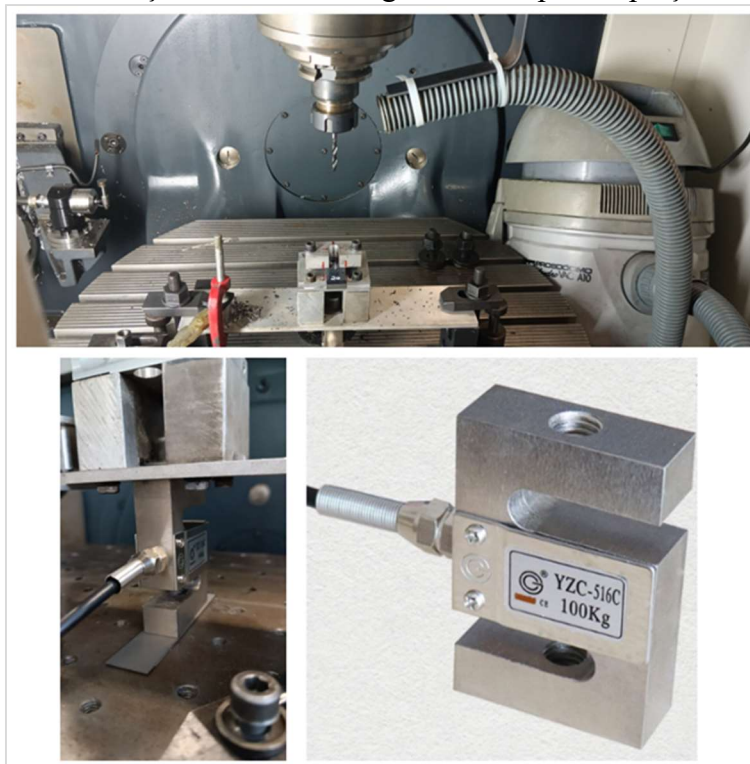
Figura 34: Sistema de fixação e célula de carga utilizada para captação da força de avanço
