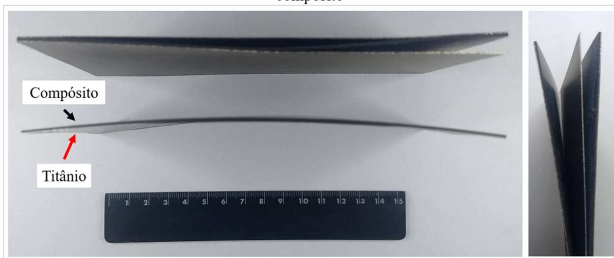
Figura 37: Fotografias que evidenciam o empenamento do conjunto da liga de titânio com compósito
