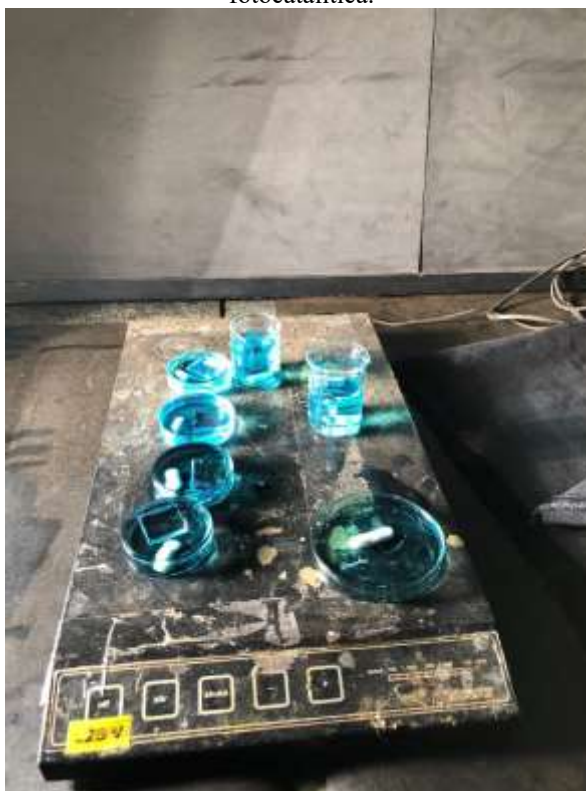
Figura 10 – Disposição dos vidros submersos em solução de azul de metileno no experimento de degradação fotocatalítica.
