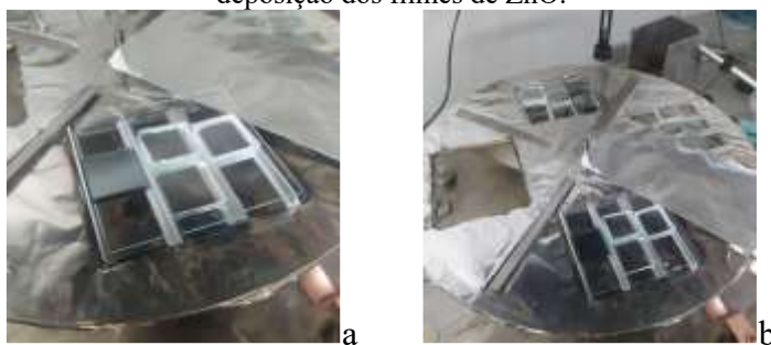
Figura 7 - a) Conjunto único e conjunto completo de amostras montada na evaporadora térmica antes da deposição dos filmes de ZnO.
