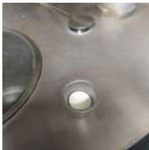
Figura 8 - Pastilha de óxido de zinco no cadinho de tântalo.
