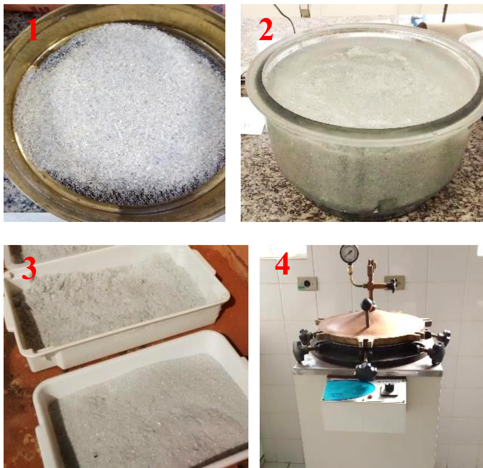
Figura 17. Esquema do processo para preparação das partículas suporte. 1. Peneiramento, 2. Imersão em ácido nítrico, 3. Secagem ao sol e 4. Autoclave.
