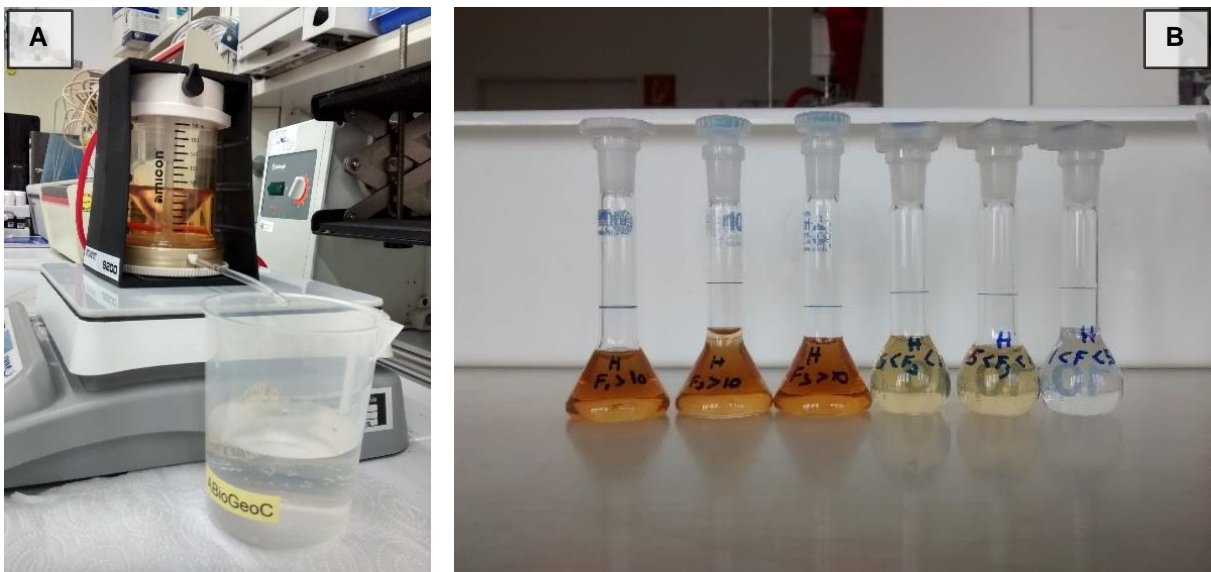
Figura 25 – Sistema de ultrafiltração e frações obtidas após fracionamento
