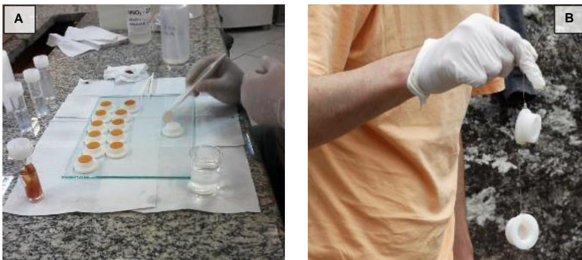
Figura 6 – Montagem e imersão de DGT em um ponto de amostragem
