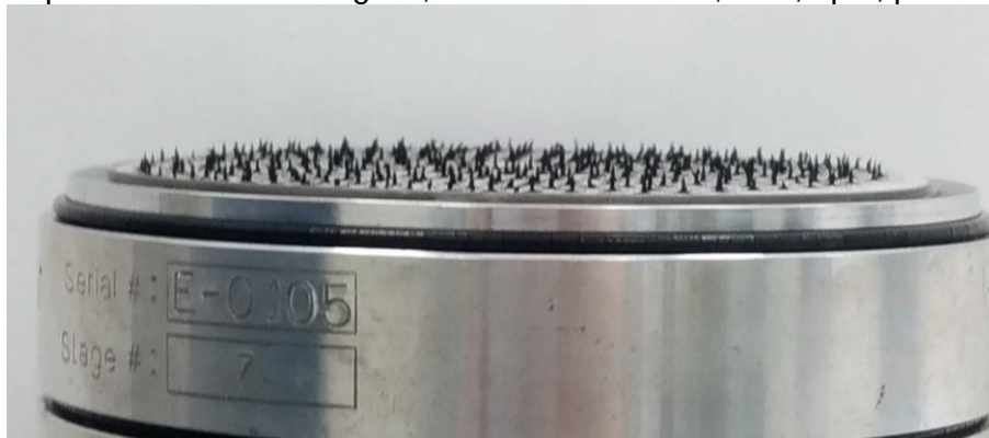
Figura 26. Aspecto do filtro do estágio 7, faixa de diâmetro 0,4 – 0,7 \mu\text{m} , para V_G = 174 \text{ m/s} .
