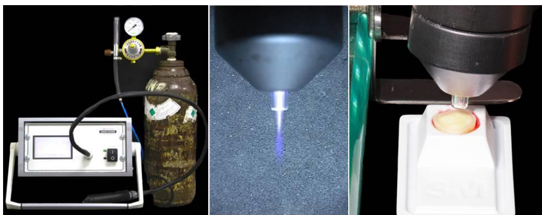
Figura 4 - A) Equipamento do plasma de superfície modelo SAP; B) Aspecto da chama do plasma no momento próprio para aplicação; C) Aplicação do plasma sobre a dentina.
