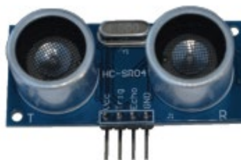
Figura 3 – Sensor ultrassônico HC-SR04
