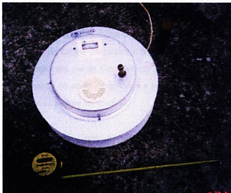
FIGURA 5.4 - Medidor de nível de água no interior do poço.
