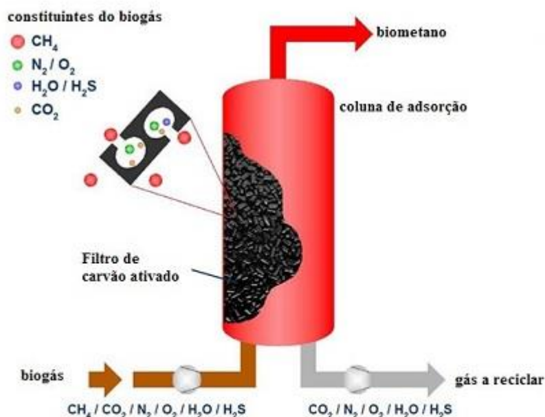
Figura 9: Esquema de captação de impurezas do biogás através de colunas de adsorção (SILVA, 2009)
