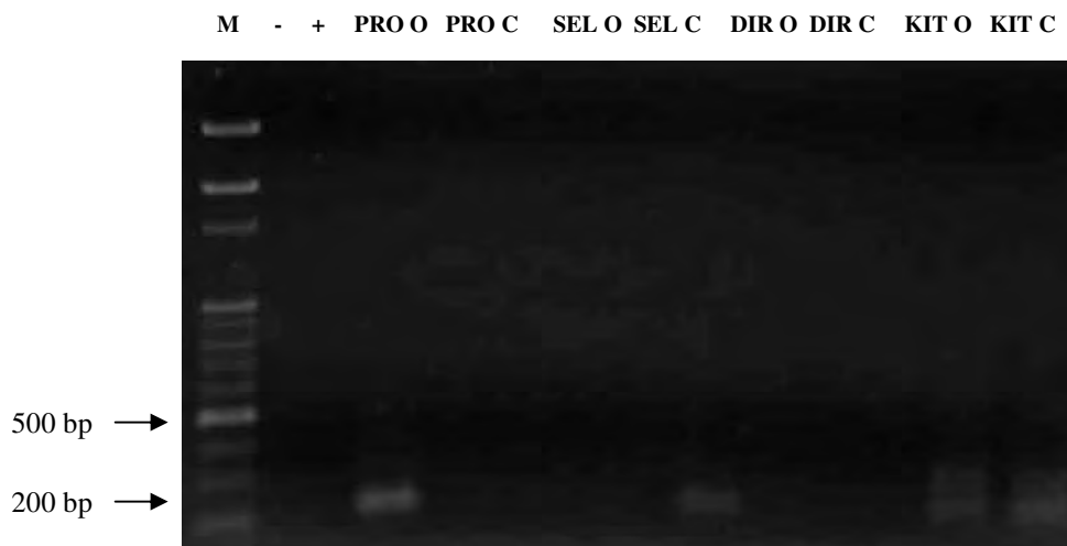
Figura 20. Eletroforese em gel de agarose dos produtos amplificados de PCR da região 16S rDNA ( primers BA338Fgc e UN518r ) a partir de amostras de DNA sem purificação. Legenda: - controle negativo, + controle positivo com Pseudomonas fluorescens ; PRO O/ PRO C - técnica Proposta em solo sob manejo orgânico e convencional, respectivamente; SEL O/ SEL C – técnica de Selbach em solo sob manejo orgânico e convencional, respectivamente; DIR O/ DIR C – técnica de Direito em solo sob manejo orgânico e convencional, respectivamente; KIT O/ KIT C – kit comercial em solo sob manejo orgânico e convencional, respectivamente; M: marcador de peso molecular 100 bp.
