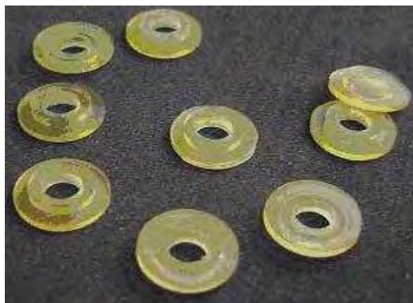
Figura 3.8 - Isoladores de poliuretano.
