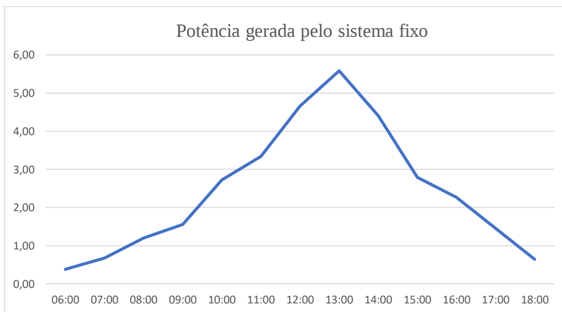
Figura 21 – Potência gerada pelo Sistema Solar Fixo.
