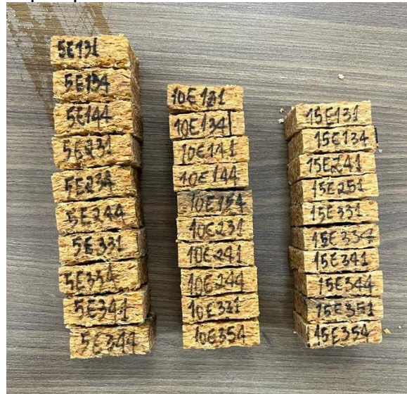
Figura 30 - cps após o ensaio de Inchamento e absorção 24h
