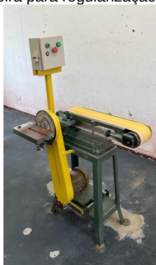
Figura 25 - Lixadeira para regularização das faces dos cps
