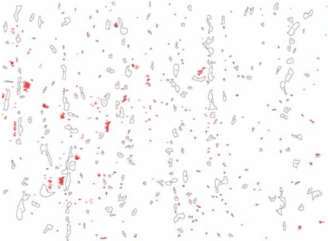
Figura 21: Resultado da Limiarização na Figura 11. Os grãos aparecem delineados. O programa gera automaticamente um número (em vermelho) que identifica cada grão.
