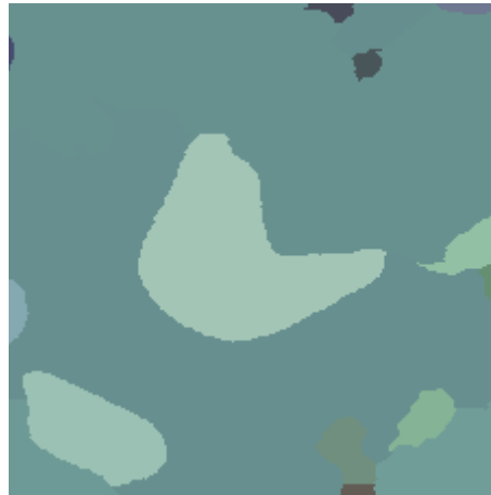
Figura 19: Recorte apresentando o resultado do Watershed para o mesmo grão branco da Figura 11.
