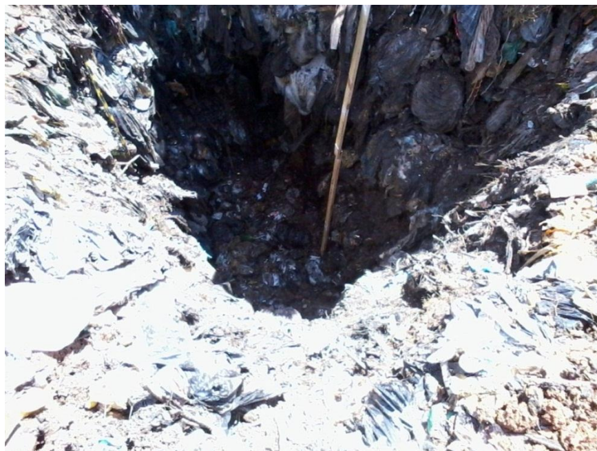
Figura 29: Detalhe para a colocação da termorresistência na massa de resíduos, onde foi posteriormente recoberta com resíduos. Fonte: Autor.
