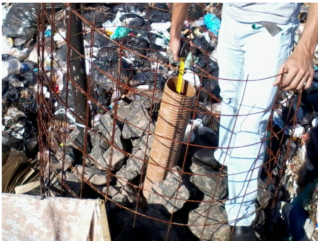
Figura 19: Medição da profundidade da camada de resíduos a partir de medição no próprio dreno de gás. Fonte: Autor.
