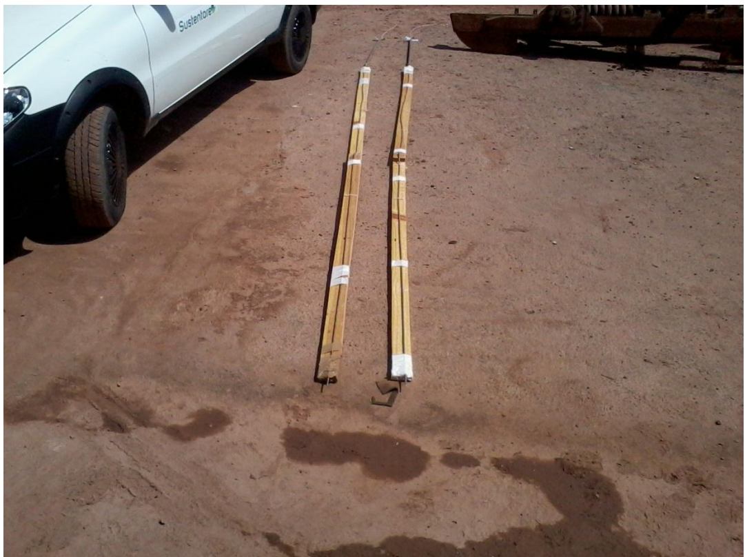
Figura 24: Termorresistências fixadas às ripas, montadas para instalação na massa de resíduos. Fonte: Autor.
