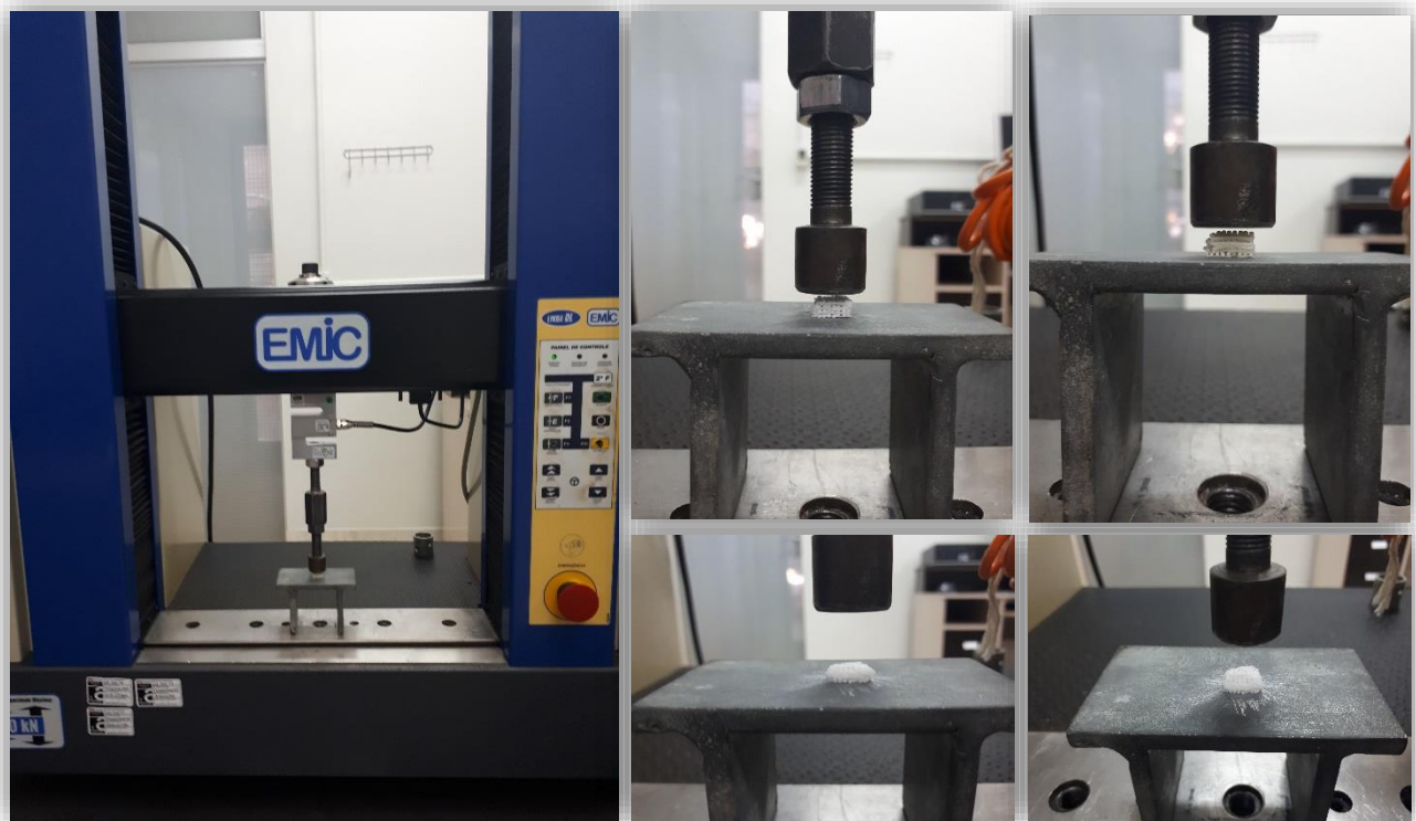
Figura 19 – Ensaio mecânico de compressão realizado. Fonte: Autoria própria
